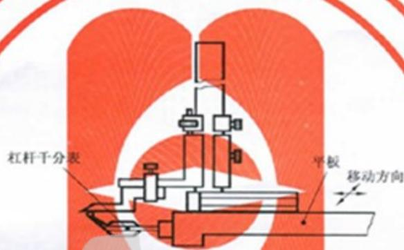
图 6 量爪测量面与底座工作面平行度测量示意图
